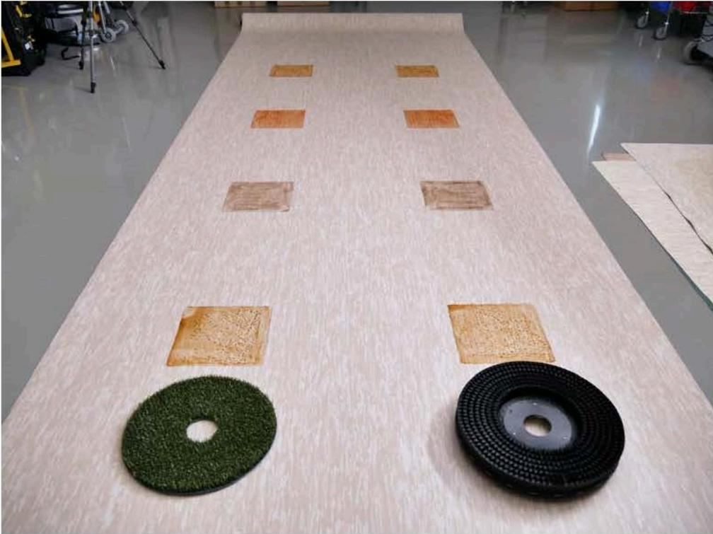
Testfläche vor dem Überfahren mit der Scheuersaugmaschine.
