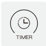
Drücken Sie auf das TIMER-Symbol, damit sich der Luftreiniger nach der gewünschten Zeit automatisch abstellt. Jede Berührung steht dabei eine Laufzeit von 30 Minuten. Die maximale Laufzeit ist 12 Stunden. Schalten Sie die Zeitschaltuhr aus, indem Sie das TIMER-Symbol für 5 Sekunden gedrückt halten. Um die verbleibende Laufzeit anzuzeigen, drücken Sie kurz auf das TIMER-Symbol.
